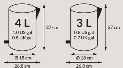
Verzinkter Inneneimer · Galvanized inner bin · Seau intérieur galvanisé · Cubo interior galvanizado · Secchiello interno zincato · Binnenemmer verzinkt
