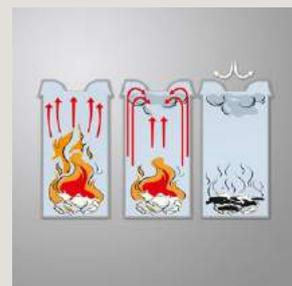
Flammenlöschende Deckelkonstruktion · Flame-extinguishing lid design · Couverture anti-incendie · Diseño de la tapa sofocador de llamas · Sistema autoestinguente del coperchio · Vlamdovende dekselconstructie
