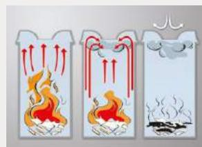
Rauchgase ersticken die Flammen durch eine spezielle Deckelkonstruktion · Smoke gases smother the flames via a special lid construction · Les fumées étouffent les flammes grâce à la construction spéciale du couvercle · Los humos ahogan las llamas gracias a la construcción especial de la tapa · Il gas di combustione spengono le fiamme grazie alla particolare costruzione del coperchio · Rookgassen verstikken de vlammen door een speciale dekselconstructie
